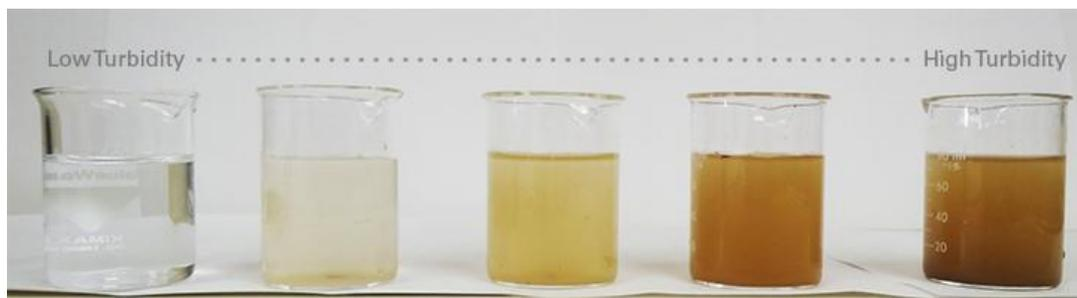
Abbildung 4: Eine Reihe von Wasserproben, die eine zunehmende Trübung (von links nach rechts) sowie Veränderungen der Farbe zeigen. Foto: Village of Chase, British Columbia
