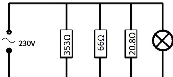
c) Die Sicherung muss in Serie zu den Geräten geschaltet sein und im Kabel sein, das direkt zur Quelle führt. (Die Sicherung ist nur an einem Ort, aber es gibt 2 Möglichkeiten sie zu platzieren.)
