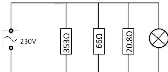
c) Die Sicherung muss in Serie zu den Geräten geschaltet sein und im Kabel sein, das direkt zur Quelle führt. (Die Sicherung ist nur an einem Ort, aber es gibt 2 Möglichkeiten sie zu platzieren.)
